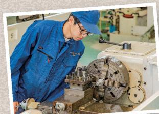
旋盤を使用して切削を行い、切削抵抗を測定する。切削条件の変化で切削抵抗の挙動や切り屑形状・切削面が変化することを理解し、切削条件を決めることができるようにする。
